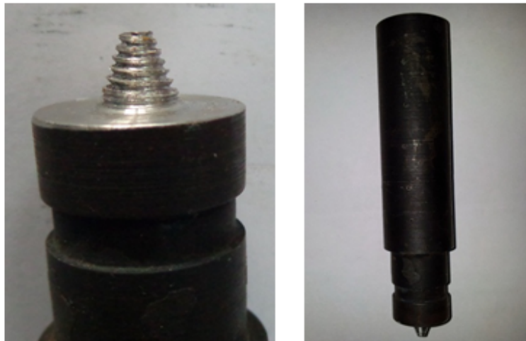
شكل (4) : اداة لحام الخلط الاحتكاكي ذات نتوء الغرز المخروطي المسنن
