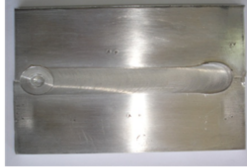
شكل (5) : وصلات لحام الخلط الاحتكاكي لسبيكتي (2024-T351,7075-T651)
