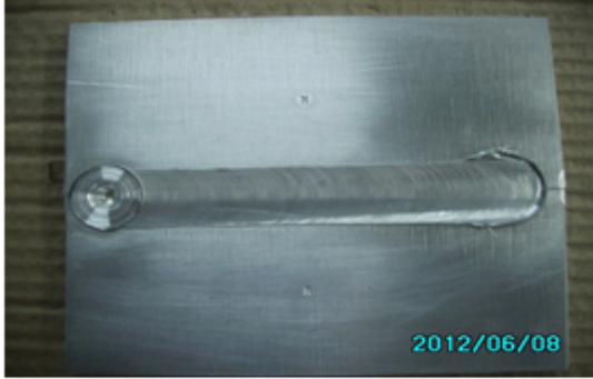
شكل (5) : وصلات لحام الخلط الاحتكاكي لسبيكتي (2024-T351,7075-T651)
